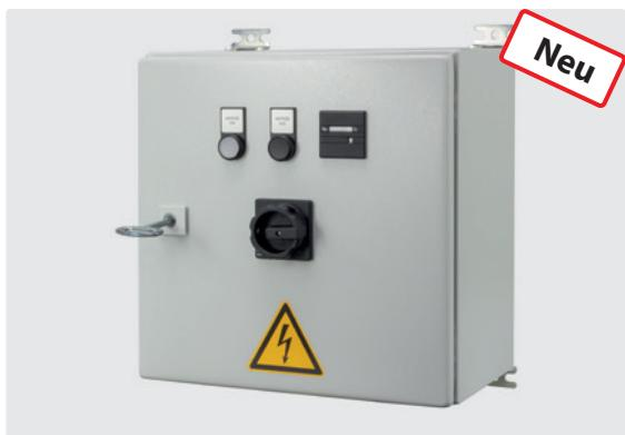
Motorsteuerung für den Betrieb von Motoren mit 4 - 7,5 kW Leistung bei 400 VAC, 50 Hz, IP 65. RAL 7035. H x B x T 380 x 380 x 210 mm. Einspeisung: 400VAC, 50Hz, 3Ph/N/PE mit Hauptschalter (Nockenschalter) 25A. Steuerspannungsaufbereitung 24VDC, 2,5A mit Vorsicherung 2A. Motorabgang mit Leistungsschütz 7,5kW und Weitbereichs-Motorschutzschalter 8-32A. LOGO-Kleinsteuergerät. 1 Betriebsstundenzähler (IP 65) und 2 Befehls- und Meldegeräte eingebaut in der Türe
