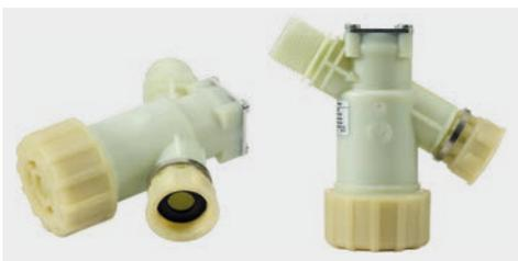
**Empfehlung:** Den Schmutzfänger mit dem Filtereinsatz vorzugsweise senkrecht nach unten installieren, um zu vermeiden, dass aufgefangener Schmutz beim Austausch des Filtereinsatzes im Gehäuse zurückbleibt.
