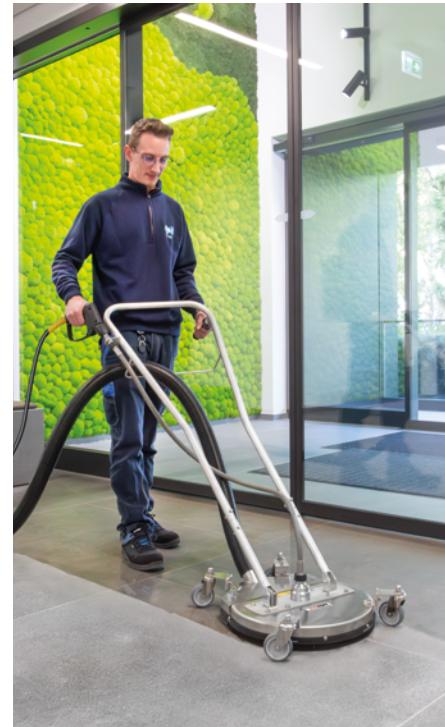
**Durchdachte Lösung:** Der integrierte Haltebügel für den Saugerschlauch sorgt für eine einfache und sichere Anwendung ohne Stolpergefahr
