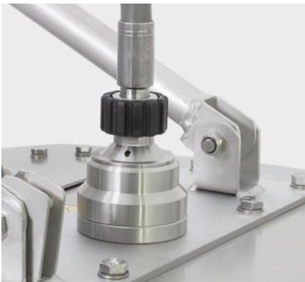
**Hochleistungsdrehgelenk:** Für höchste Beanspruchung mit langer Lebensdauer. 3-fach kugelgelagert mit extrem hochwertigen Hartmetall-Dichtelementen
