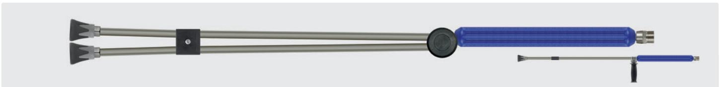
M22 AG. Strahlrohr mit umpritzter Isolierung, Ventil ST-154 seitlich und Düsenschutz ST-10 mit Niederdruckdüse & Muffe 1/4" IG. Max. 500 bar / 150 °C
