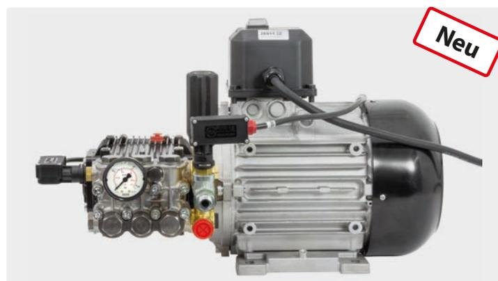
400 Volt. Alle Ausführungen mit Umlaufventil, verzögerter Totalstopp-Steuerung, Druckmanometer, Elektrokabel 5 m und Ein-/Ausschalter. Eingang 1/2" IG, Ausgang 3/8" AG. Max. 85 °C bei mind. 2 bar Vordruck.
