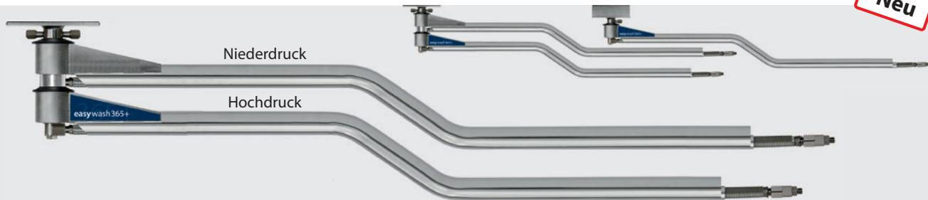
Edelstahl. Montagefertig für die Installation mit integrierten Qualitätsdrehgelenken, professionellem Hochdruckschlauch mit Zugentlastungsfeder sowie integriertem Knickschutz. Achse 2-fach gelagert sowie permanent geschmiert. Speziell für den Einsatz von 2 Deckenkreiseln nebeneinander geeignet und für 2 unterschiedliche Medien und Anwendungen entwickelt. Max. 275 bar / 90 °C
