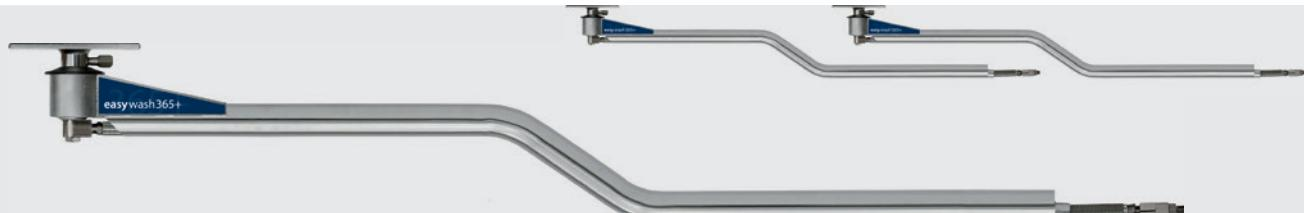
Edelstahl. Montagefertig für die Installation mit integrierten Qualitätsdrehgelenken, professionellem Hochdruckschlauch mit Zugentlastungsfeder sowie integriertem Knickschutz. Achse 2-fach gelagert sowie permanent geschmiert. Speziell für den Einsatz von 2 Deckenkreiseln nebeneinander geeignet. Max. 275 bar / 90 °C
