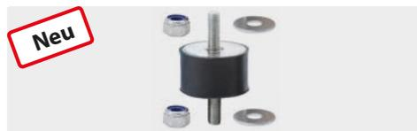
Gummipuffer Typ A. M10 x 28. Inkl. Schrauben und Unterlegscheiben. Stahl / elastisches Naturkautschuk 55°. Federsteifigkeit: 500 N/mm. Belastung: 2000 N
