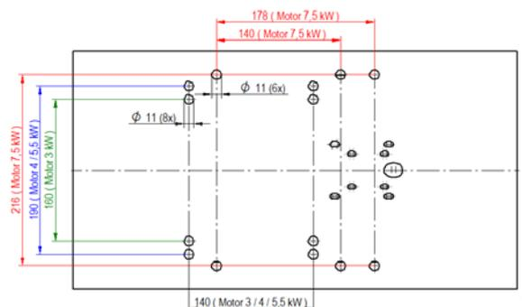
**Schnelle und sichere Montage:** Vorgesehene Bohrungen vereinfachen die Anbringung der Motoren und der unterseitigen Filtergehäuse.
