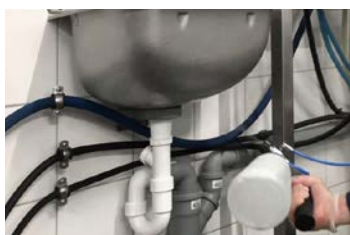
Partieller Einsatz: Auch als Handgerät eingesetzt, können selbst kleinste Ritzen und Spalten mit dem Kalt-Nebel erreicht werden.
