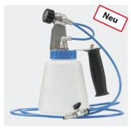
Desinfektions-Kalt-Nebelgerät ST-83. Für Druckluftanschluss 3 bar, 180-220 l/min. Edelstahl/Kunststoff
