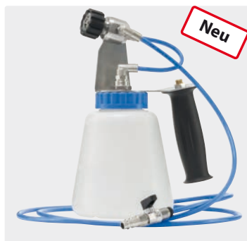
Desinfektions-Kalt-Nebelgerät ST-83. Für Druckluftanschluss 3 bar, 180-220 l/min. Edelstahl/PVC
